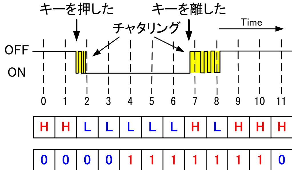
キーを離したタイミングでは、サンプル7と8の間でチャタリングが発生して、**H**、**L**の判定もバタついています。これを除去するために、仮に**L**が3回続ければキーが押されている(論理1)、**H**が3回続ければキーが離された(論理0)と判断する事にします。
