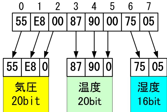
ちなみに、今回の BME280では、2byte目と5byte目のデータは 常時 00 です。 将来的に分解能の高いセンサデバイスが出来た時を想定して 20bitにして いるのかもしれません。
