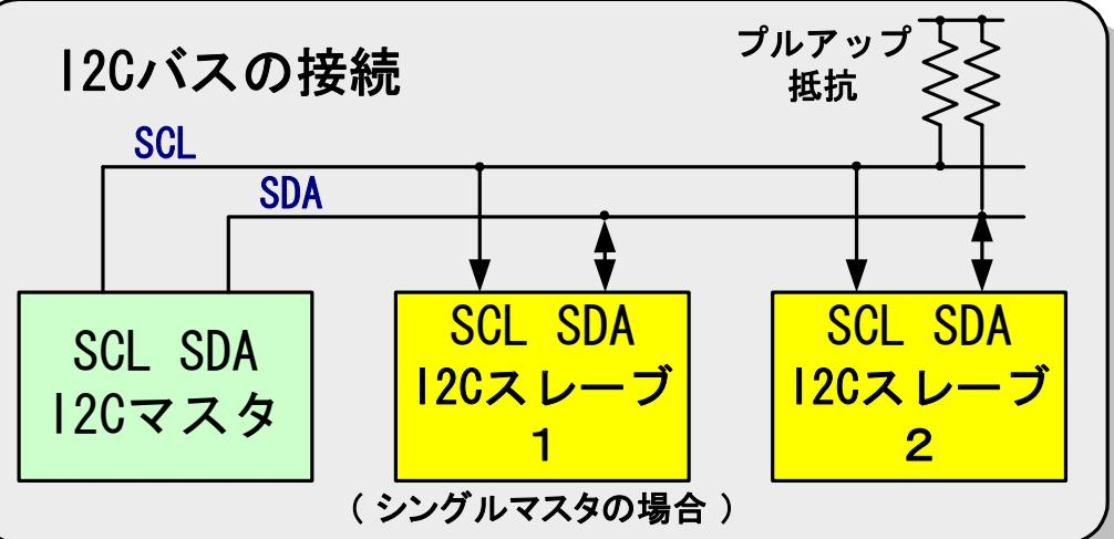
I2Cバスは、SCL（シリアルクロック信号）と SDA（シリアルデータ信号）の、2本の信号線で構成されています。
