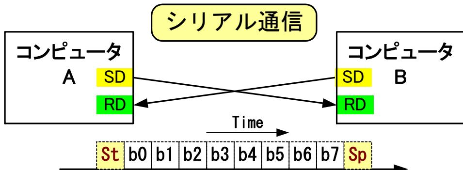
上記の図で、2台のコンピュータAとBの間の2本の矢印の付いた線ですが、矢印の向きはデータ転送される方向を示します。線の両端には、SD、RDの名前を付けてますが、センドデータ送信線、レシーブデータ受信線の意味です。
