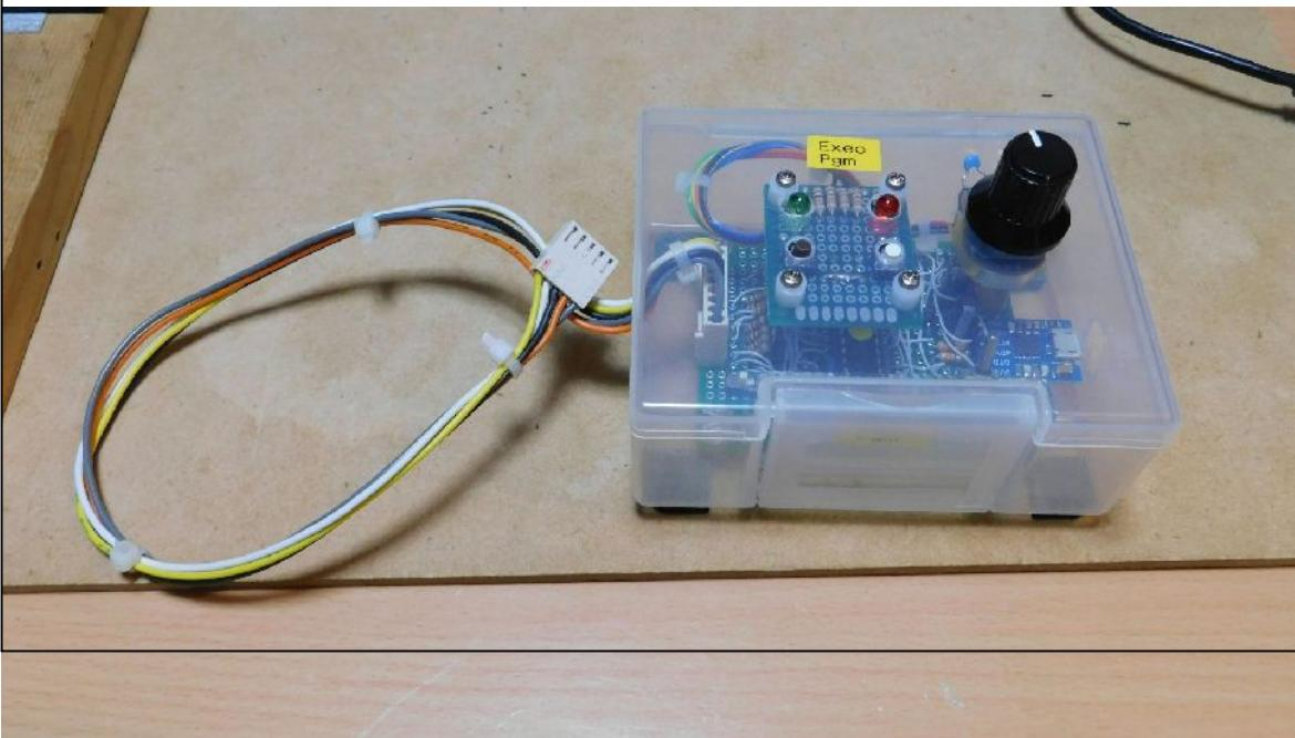
今回の 改造箇所は、元々のプルアップ抵抗が、線を長く引き出す関係もあり、 $1\text{K}\Omega$ に していました。今回の LCDを使うには プルアップ抵抗を  $10\text{K}\Omega$ にする必要があります。で、場合によつては もう少し低い抵抗値にしたい場合もあると、思われる所以、トグルスイッチで  $10\text{K}\Omega$ と  $2\text{K}\Omega$ を 切り替えられるようにします。
