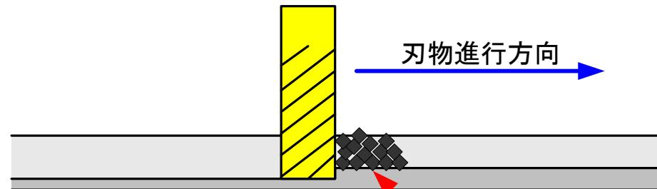
切削溝が深くなると、左右に壁が出来るため 切り子の逃げ場が、なくなり、刃物の進行方向前に 切り子が、固まってたまる傾向があると思われます。
