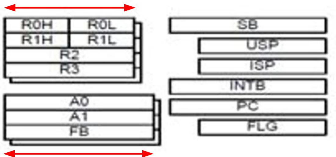
という事で、R8Cマイコンの ハードウェアデータシートの レジスタ構成図と比べると 明らかに レジスタ長の 図形上の表示が、**A0, A1, FB, SB** の長さが、間違います。繰り返しますが、PCと INTB 以外は 16bit です。
