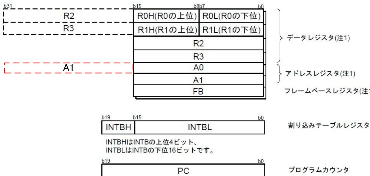
R0レジスタは、R2レジスタを 上位WORDとして連結して、32 bit レジスタとして扱う事が出来ます。 R3 レジスタと R1レジスタも 連結して 32 bit レジスタとして扱う事が出来ます。 元の図には書いて無かったので、私が A0 レジスタの左に 赤の点線で A1 レジスタを 連結する 図を 追加しました。 これにより、A1:A0の 32 bitの ポインタとして扱えます。
