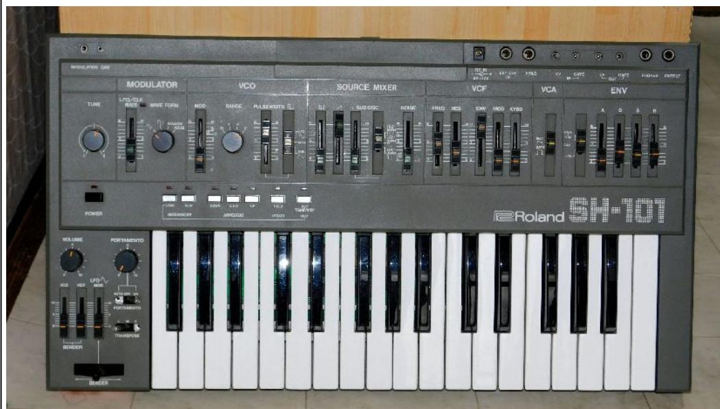
最初 激しくボリュームのガリ音がしました。ボリュームを動かさなくても大きい音で、バリバリ激しい音がしてました。ただ、ボリュームを回してある特定位置では、音が止るので、その時の音を聞くとわりとまともでした。という事で、ボリューム等の接触不良を何とかすれば使えるようだ。という事で分解して、接点復活材をボリューム内に吹き付け、ボリュームツマミを行ったり来たりさせて、かなり調子良くなりました。
