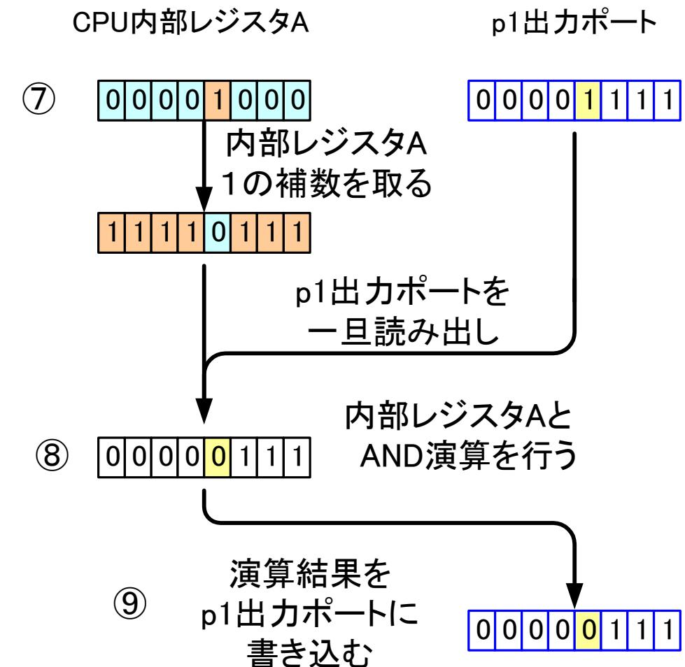
何故、ビットセット命令、ビットクリア命令の動作説明を行ったかというと、I2Cの I/Oエクスパンダー MCP23017も、先頭ページで説明した通り、ポート内の単独ビットの書き換えは出来ません。で、それをソフトで、ビットセット、ビットリセットを行う場合、基本的に 前述のビットセット命令、ビットクリア命令と同様に、一旦出力ポートの値を読み込んで、AND、OR命令を行い再書き込みします。で、当然ですが 400kbps の I2Cシリアル通信でデータをやり取りするので、一旦読んで書き込むという 二度手間的な事を I2Cで行うと処理が遅くなるのは容易に想像が出来ます。そして、ビット毎に 8bit分 あるいは 16bit分 連続してビット設定を行うと 更に遅くなります。
