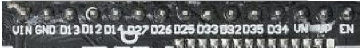
上の基板ピンのシルク印刷ですが、VINは USBケーブルからの 5Vです。 GNDは そのまま グランドです。 D13、D12、D14、D27、D25、D33、D32、D35、D34 は GPIOの bit番号です。
