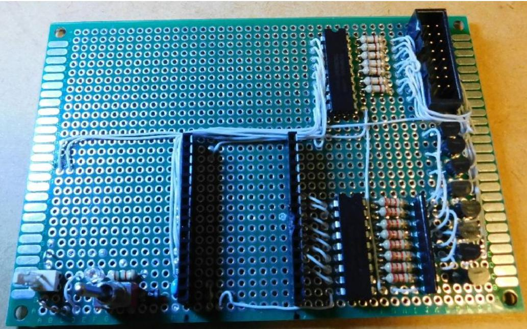
上の画像は、今回作成したデジタル時計用のベース基板です。中央下側の 縦2列に並んだピンソケットに ESP32モジュールが、挿入
