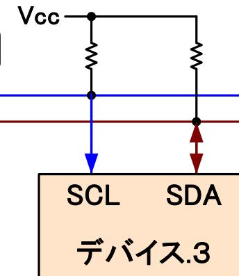
I2Cは SCL:シリアルクロック信号、SDA: 双方向データ信号の 2本の信号線で構成されます。標準的な転送速度は 400Kbpsです。デバイスによっては、更に早い物もあります。また、Read/Writeコマンドに 7bitのアドレスも付くので、2線に アドレスの異なる複数のデバイスを接続する事が出来ます。
