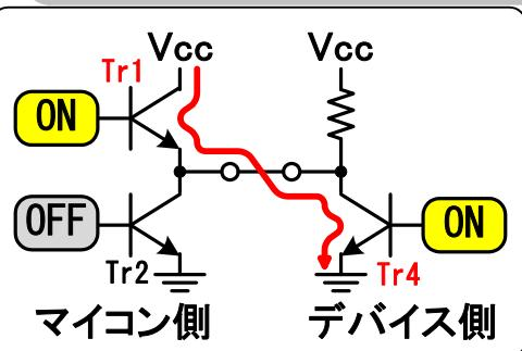
左の場合、左側のトライステートの上側のトランジスタが、ONして、右側のオープンコレクタのトランジスタが ONした場合に限って 大きな電流が流れ、トラブルが発生します。
