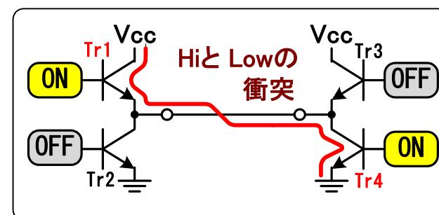
左の場合、ONしている Tr1から Tr4を 通り 大きな電流が流れ、トランジスタを壊しかねない。
