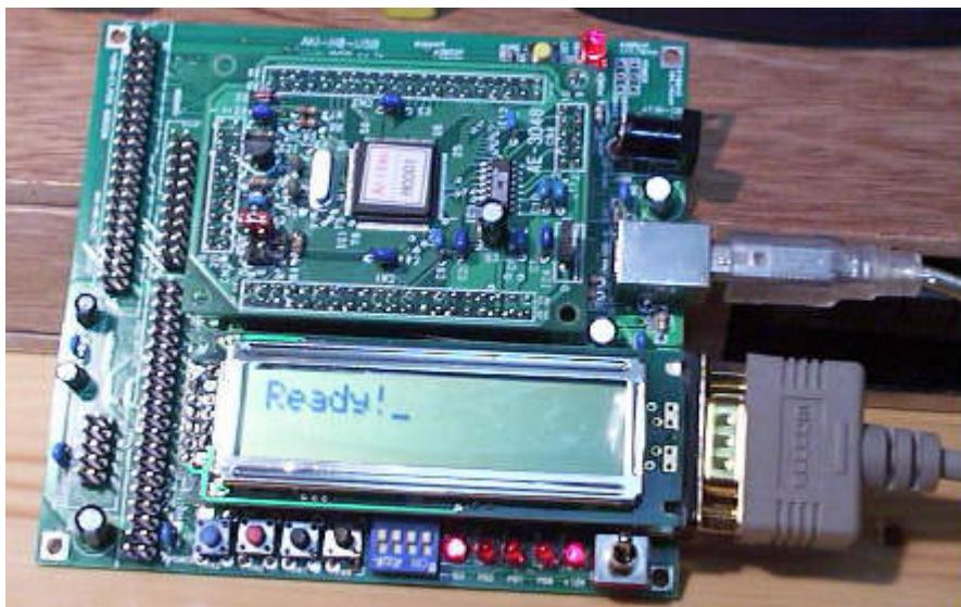
構成は、USBインターフェースが付いた親基板上に、CPU基板と LCDが乗った形になっています。
