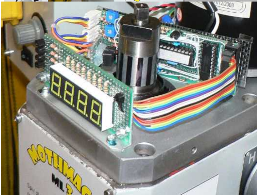
実装後の画像 センサ位置をストライプ模様から 2mm程度離して取り付けています。
